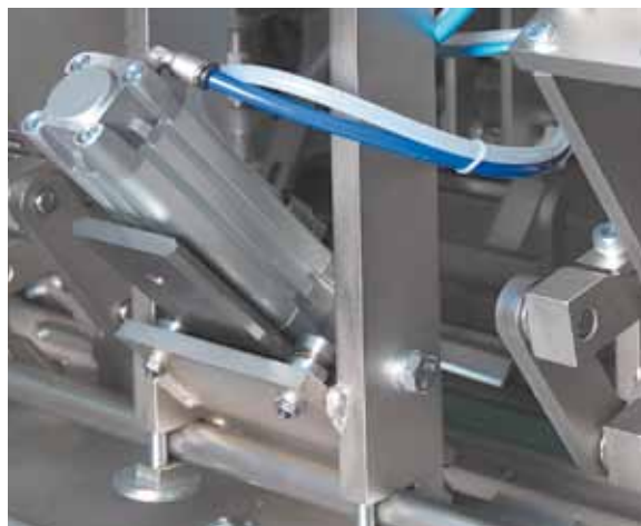
Corner folding and long side doubling system Gruppo formatura angoli e raddoppio fiancata Formgebungseinheit der Ecken und der verdoppelte Seitenwände Grupo formación ángulos y pared doble lateral
