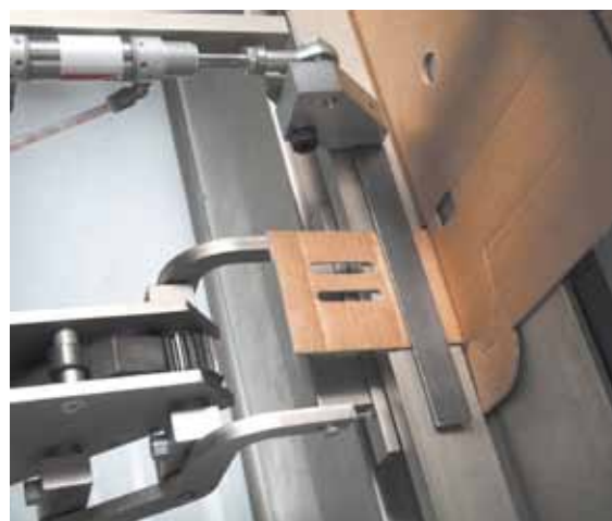
Corner folding with inner contrast system Gruppo formatura angolo con contrasto interno Eckenformgebungseinheit mit innerem Anschlag Grupo formación ángulo con contraste interno
