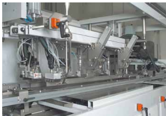
Corner pressers lifting system Gruppo eliche sollevabili Hebbare Schnecken Grupo hélices con posibilidad de elevación
