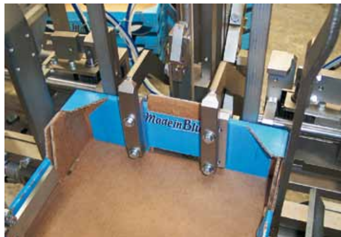
Long and short side doubling Raddoppi testate e fiancate Verdoppelte Kopfseiten und Seitenwände Paredes dobles en partes superiores y en laterales
