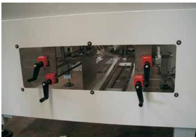
Central adjustment units for quick format changeover Regolazioni centralizzate per rapido cambio formato Zentralisierte Einstellungen für schnellen Formatwechsel Regulaciones centralizadas para rápido cambio de formato
