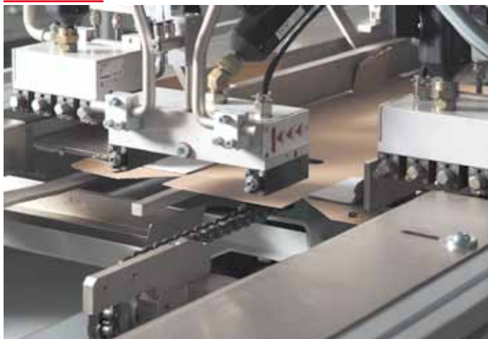
Additional glue gun for short doubling side Pistola aggiuntiva per raddoppio in testata Zusätzliche Pistole mit verdoppelten Kopfseiten Pistola adicional para pared doble de las partes superiores
