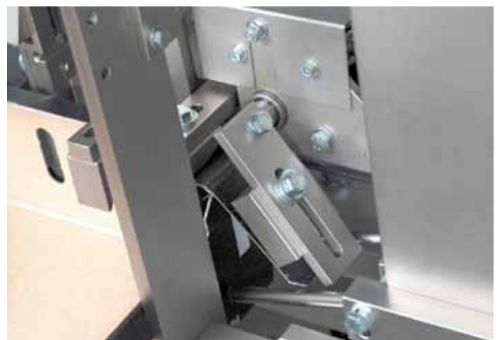
Side flaps positioning system Centratura alette laterali Zentrierung der seitlichen Laschen Centrado de las aletas laterales
